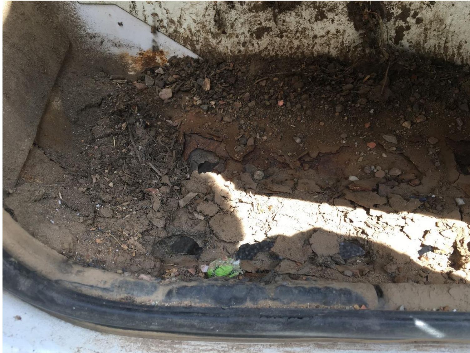
Bild 3, durchgerosteter Einstieg, Fahrerseite - Detail
