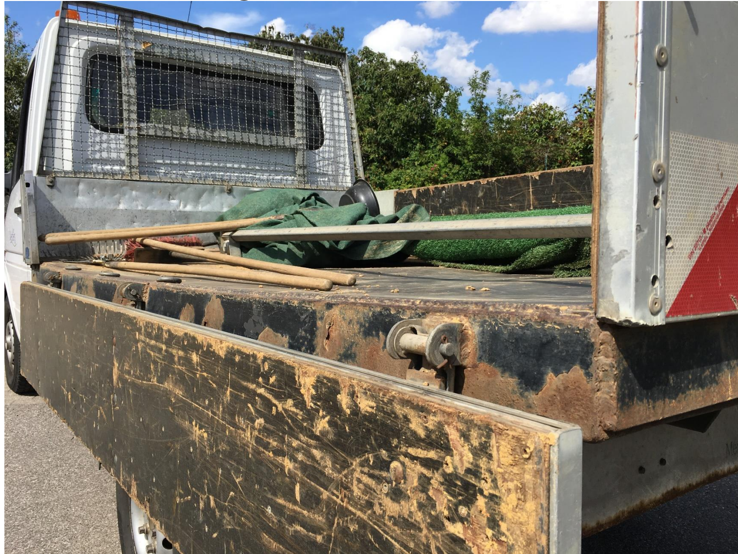
Bild 12, verbogene Ladefläche, Gesamtansicht
