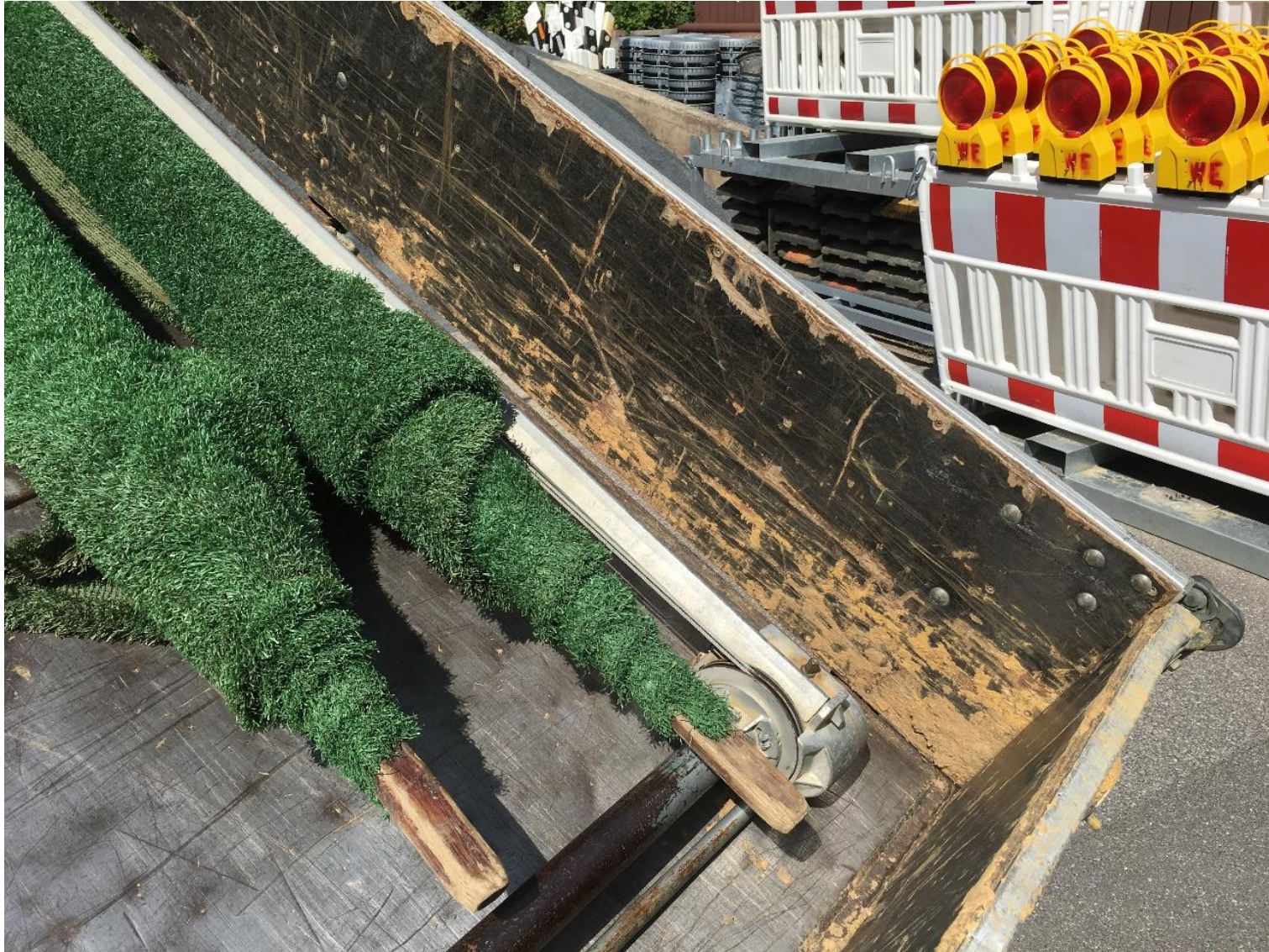
Bild 8, großes Spaltmaß an Bordwand, FR rechts – Detail
