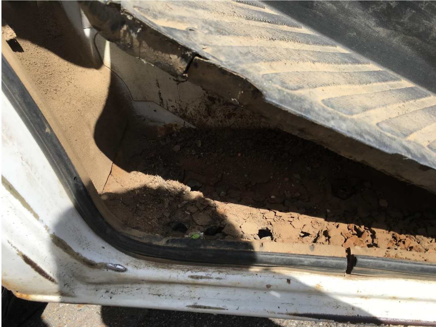
Bild 2, durchgerosteter Einstieg, Fahrerseite
