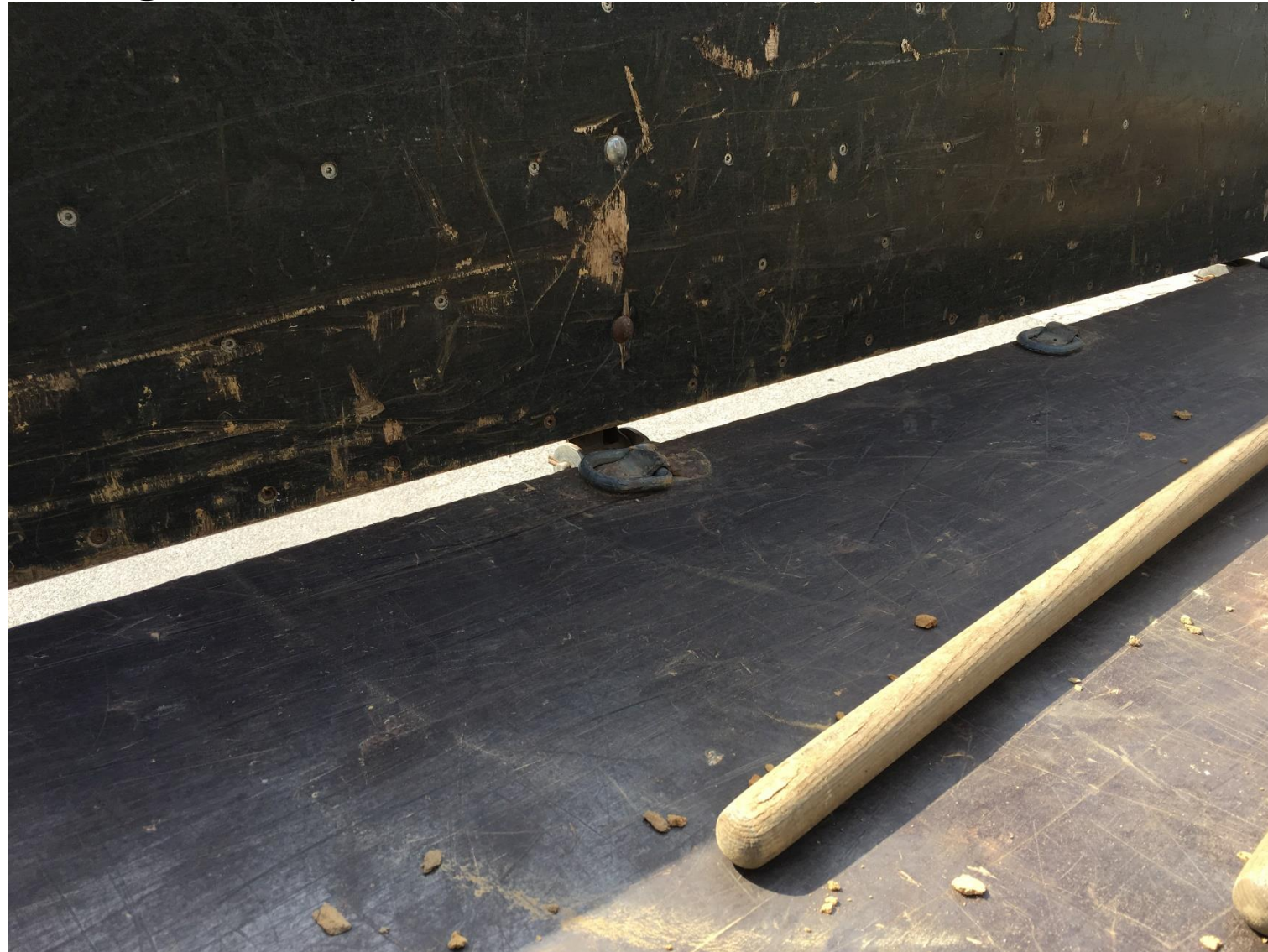
Bild 6, großes Spaltmaß an Bordwand, FR links - Detail
