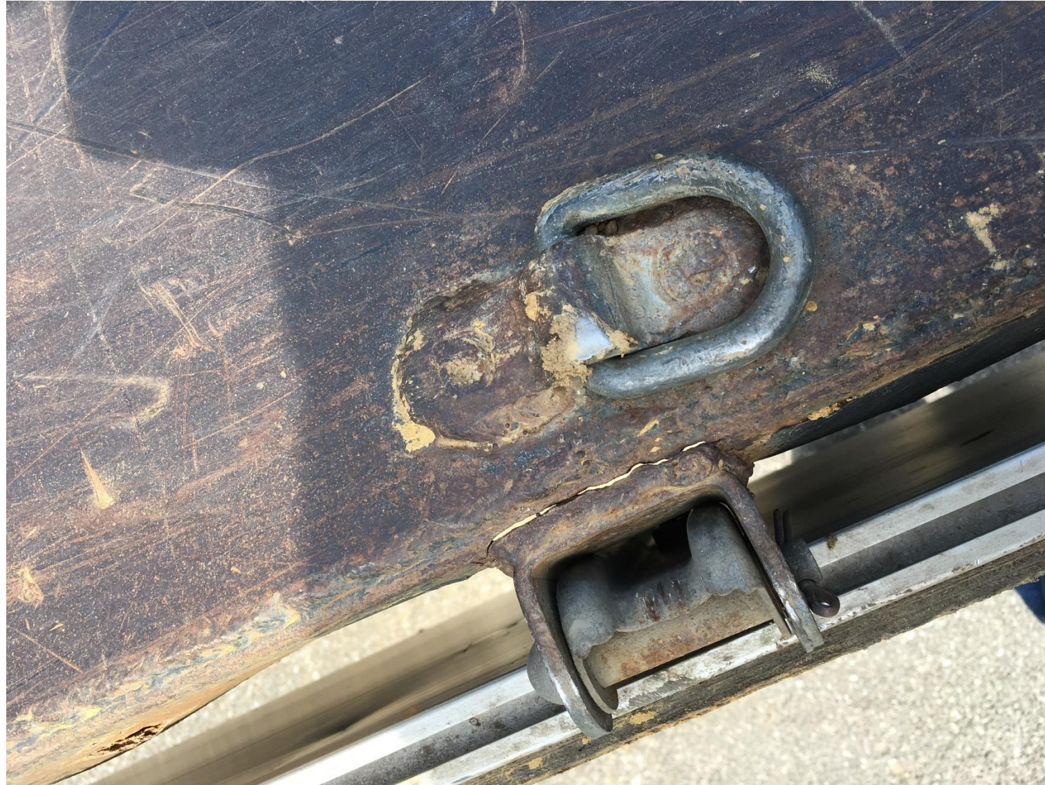
Bild 9, herausgerissenes Bordwand - Scharnier
