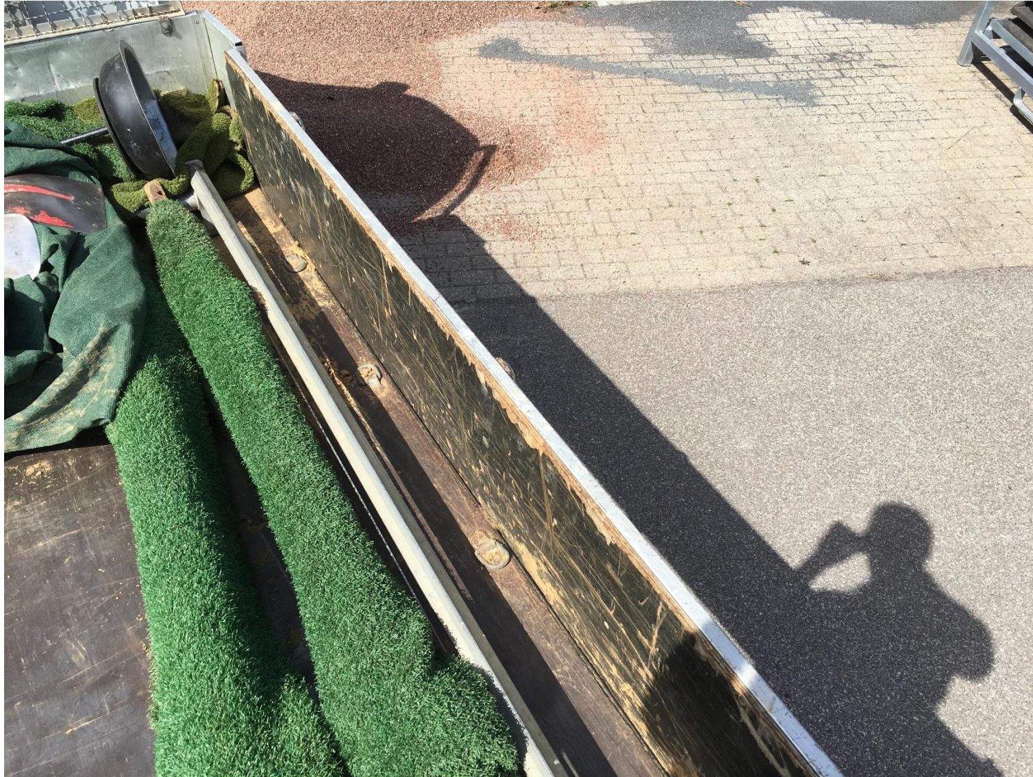
Bild 5, großes Spaltmaß an Bordwand, FR rechts
