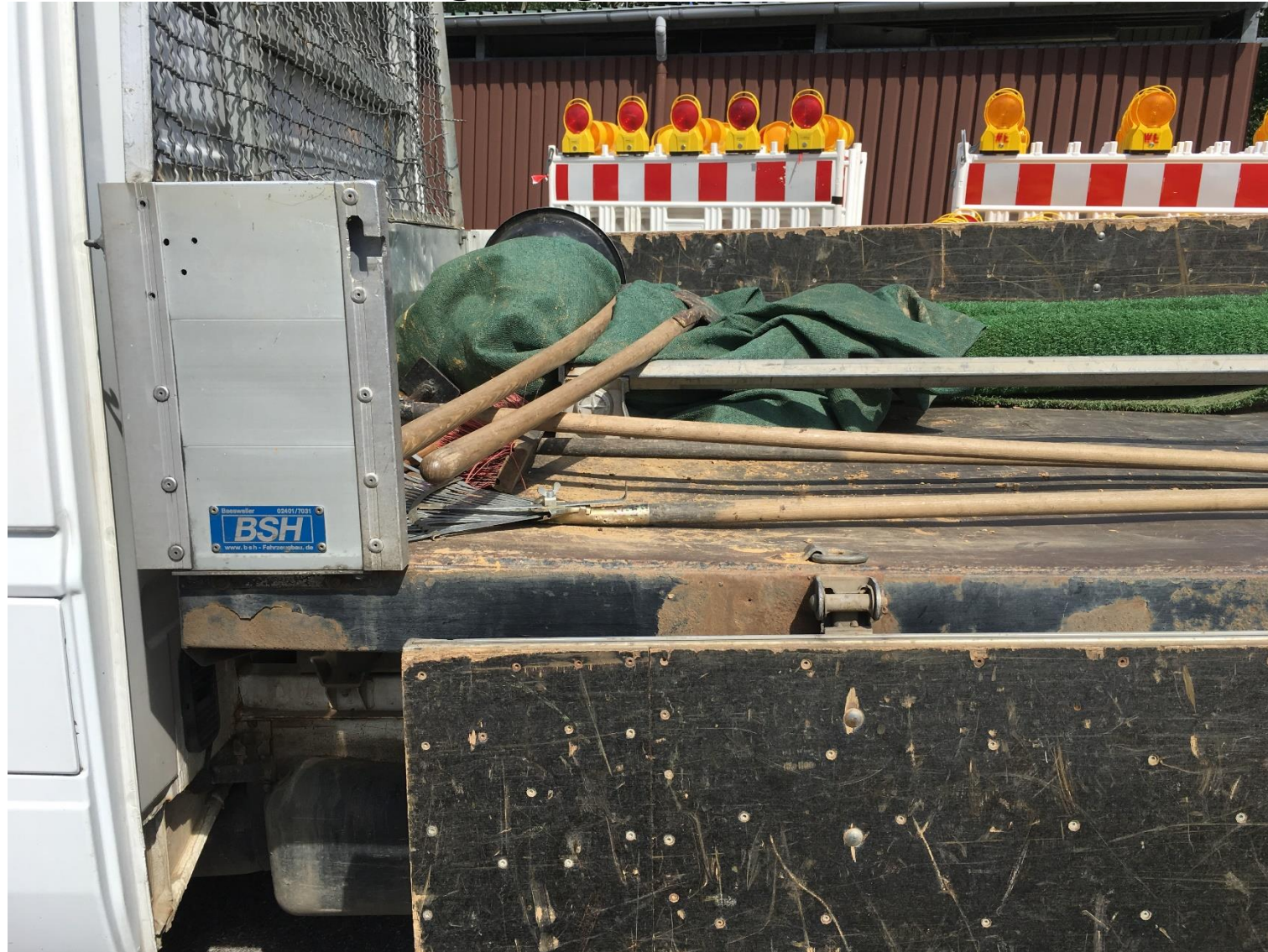
Bild 11, durchgebogener Ladeboden, Front
