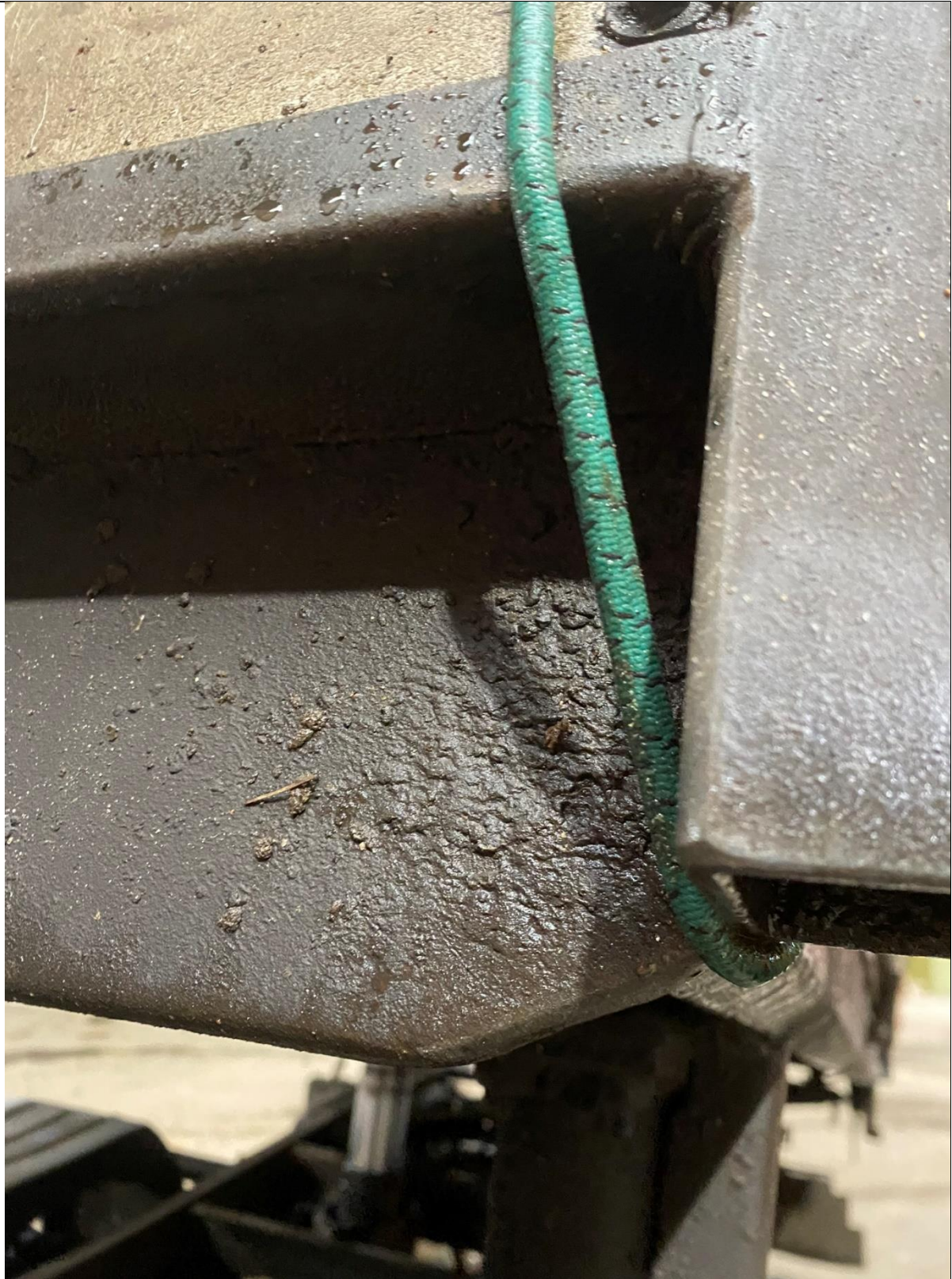
Einsetzende Korrosion an Kipperbrücke
