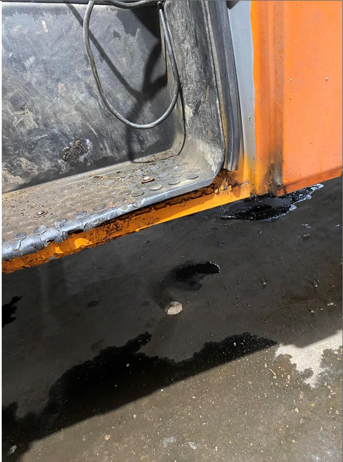
Einstieg – Fahrertüre; gut erkennbar: in der Vergangenheit bereits vorgenommene Ertüchtigungen
